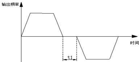
图 F8-3 正反转死区时间示意图
