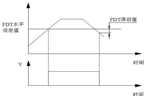
图 F8-5 频率水平检测示意图
