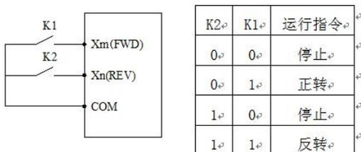
图 F4-2 二线式控制模式 1 示意图
