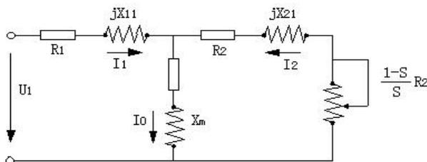
图 F1-1 异步电机稳态等效电路图
