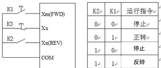
图 F4-5 三线式控制模式 2 示意图
