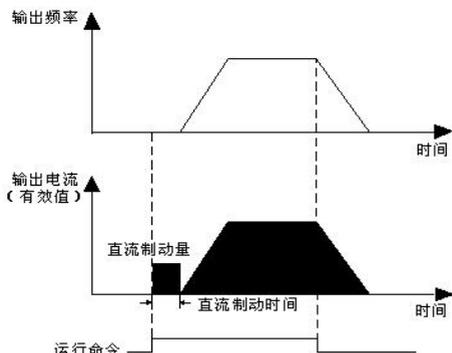
图 F6-2 起动直流制动示意图
