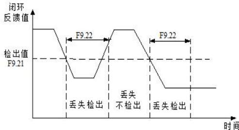
图 F9-4 闭环反馈丢失检出时序图
