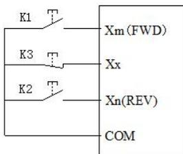
图 F4-4 三线式控制模式 1 示意图
