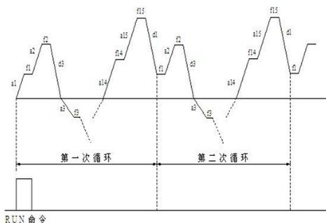
图 FC-1 PLC 单循环后停机示意图
