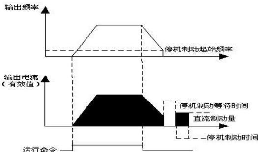
图 F6-4 停机直流制动示意图
