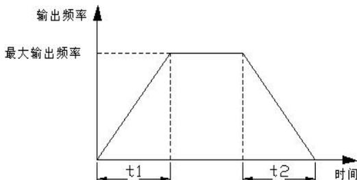
图 F0-2 加速时间和减速时间示意图
