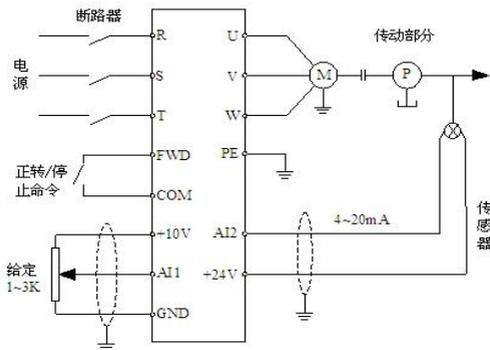
图 FA-1 模拟反馈控制系统示意图
