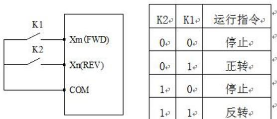
图 F4-3 二线式控制模式 2 示意图
