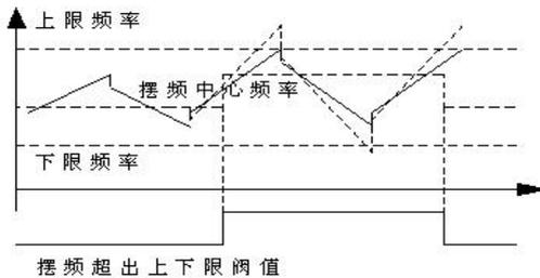
图 F5-1 摆频幅度限制示意图
