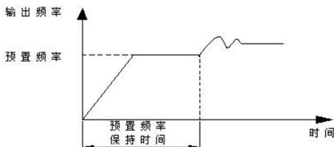
图 FA-4 闭环预置频率运行示意图
