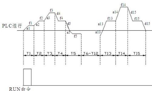
图 FC-2 PLC 单循环后保持示意图
