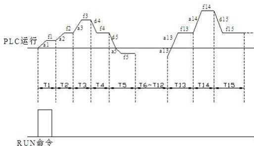
图 FC-3 PLC 连续循环示意图
